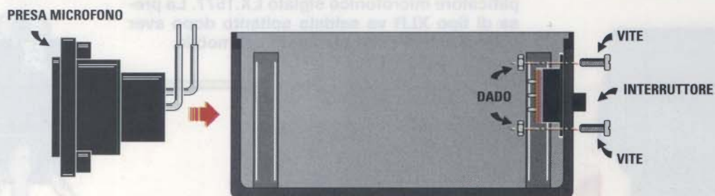
Fig.5 Per prima cosa bloccate con due bulloni su un lato del contenitore l'interruttore di accensione, che si incastra perfettamente nella fessura predisposta. Sul lato opposto infilate fino in fondo la presa microfono con i terminali rivolti verso l'alto. Anche questa presa entra in maniera precisa nella sua fessura.
