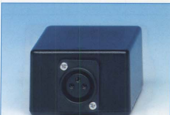
Fig.15 Foto della piccola scatola di plastica nera vista dal lato della presa femmina di tipo XLR ad ingresso bilanciato. Questo contenitore viene fornito già forato.
