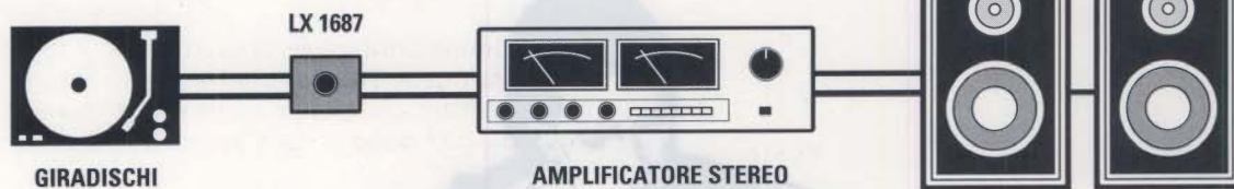
Fig.5 Il soppressore di rumore e fruscio va collegato tra il giradischi e lo stadio amplificatore.
