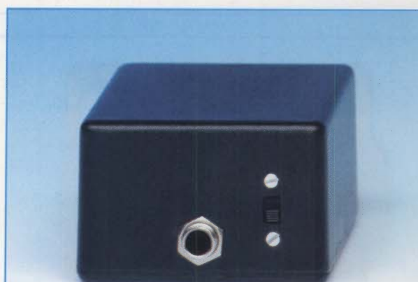
Fig.16 Sul lato opposto a quello della presa XLR dovete collocare l'interruttore di accensione e la presa d'uscita jack stereo per il collegamento all'amplificatore.
